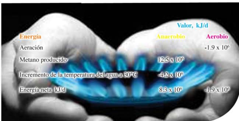
Comparación del balance energético para los procesos aerobios y anaerobios para el tratamiento de aguas residuales (Gasto = 100 m 3 /d; Carga, 10 kg DQO/m 3 , 20 °C)
